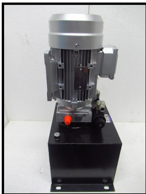
Imagen 1: Imágenes de Central hidráulica de doble efecto 380 VAC
